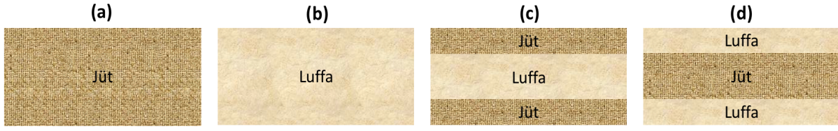
Şekil 3.3. Test numunelerinin tasarımları: homojen (a) jüt ve (b) luffa numuneler ve bunların hibrit (c) jüt-luffa-jüt (JLJ) ve (d) luffa-jüt-luffa (LJL) kompozitleri
